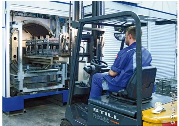
Die Anlage kann sowohl von der Vorderseite mit dem Gabelstapler als auch von der Rückseite vollautomatisch beladen werden
