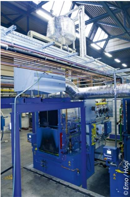
Die Abwärme der Härtereiföfen wird für die Wärmerückgewinnung genutzt
